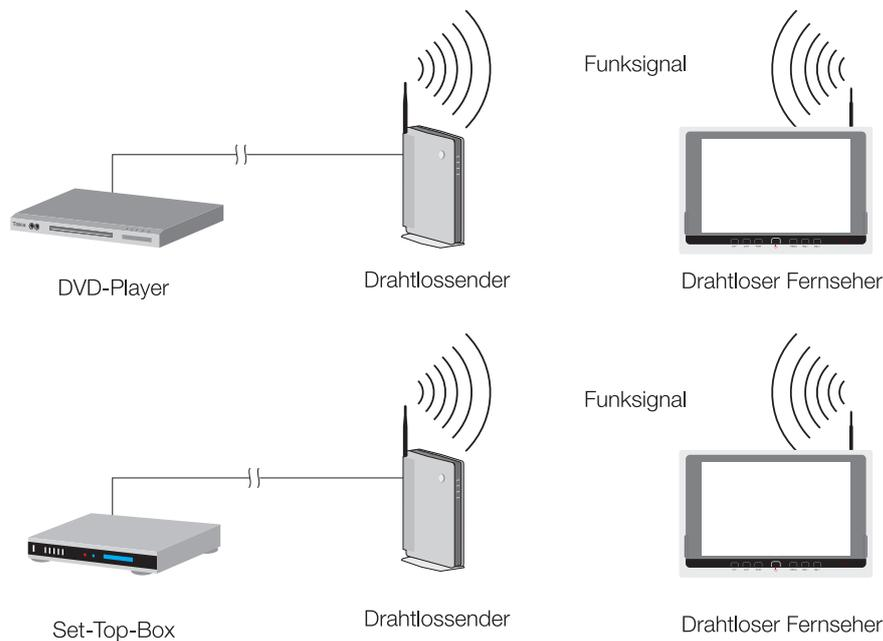
Durch unser Drahtlossystem können Sie einfach überall im und ums Haus fernsehen. Sie verbinden die Bildquelle mit dem Sender und dieser überträgt das Signal drahtlos an den Fernseher. Die Reichweite des Senders beträgt ca. 60 Meter.
